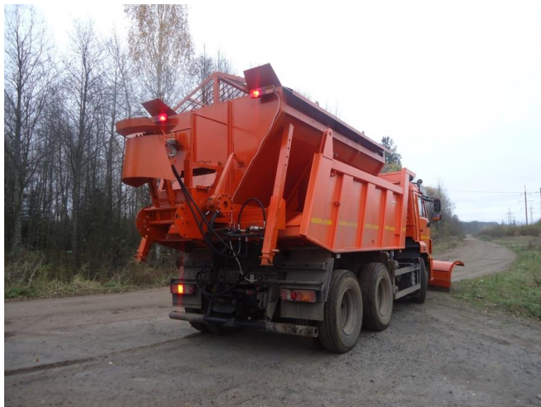
Пескоразбрасывающее оборудование с опорами хранения.
