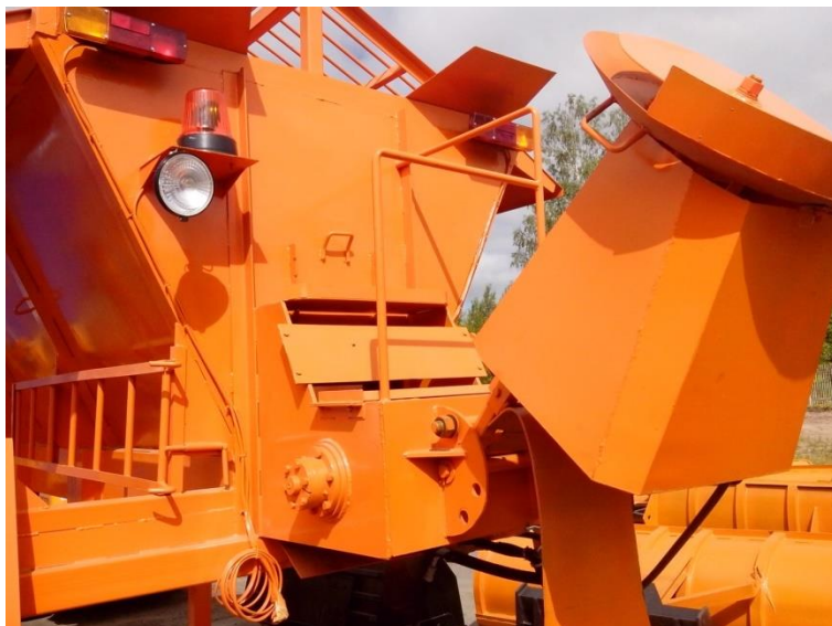
Опорный подшипник приводного вала транспортёра.
