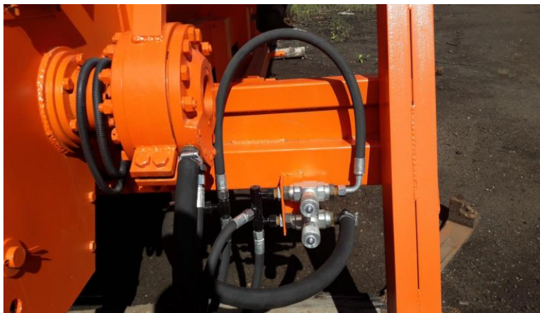
Гидромотор РПГ6300 с ручными регуляторами управления скоростью подачи транспортера и вращения разбрасывающего диска.
