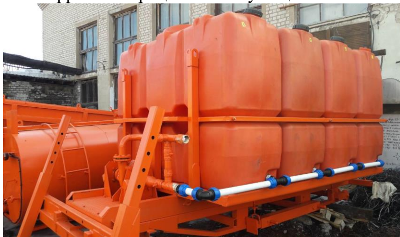
Поливомоечное оборудование с пакетом полипропиленовых баков.
