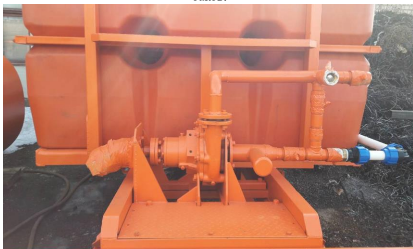
Обвязка поливмоечного оборудования с накопителем из полипропиленовых баков.
